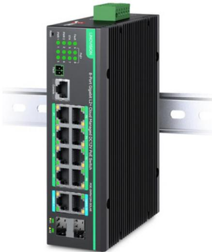
PoE-SWR612GM-SOLAR 是一款工业级12口 L2+ 可远程管理太阳能PoE交换机，具备冗余双路 8~57V DC 宽压输入。它可直接高效地工作在太阳能供电系统或房车电池系统中，无需额外配置 DC12/24V 转 DC48V 升压器。该交换机提供 8 个符合 IEEE802.3af/at 标准的 PoE 输出端口，可为 IP 摄像机、IP 电话、无线网桥等受电设备 (PD) 供电，或通过额外的 PoE 分离器为 DC12/24V 设备供电。它是一款 L2+ 可管理交换机，具备完整的二层 (L2) 管理功能及部分基础的三层 (L3) 功能。此外，还可通过 RemoteMonit 云平台或第三方云平台进行远程管理。
