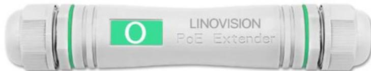
POE-EXT3001GP 是一款千兆防水单端口延长器。该设备提供两个 10/100/1000Mbps RJ45 端口，其中输入端口连接至 PSE 设备，输出端口连接至 IP 终端 PD 设备。两个延长器配合远距离 PoE 交换机使用时，可将 10Mbps 网络数据传输距离延长至 720 米。无需配置，即插即用。
